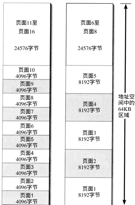
图13-1 不同的CPU使用的示例进程地址空间
